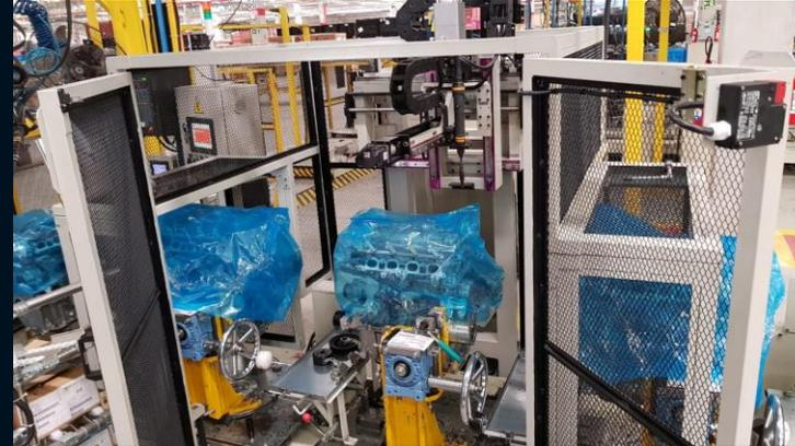
**Máquina aperto automática tampa das válvulas;**
